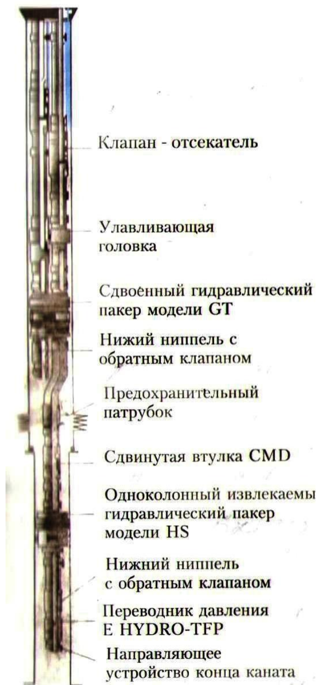
Рис. 3.18. Двухлифтовая установка компании Baker Hughes
