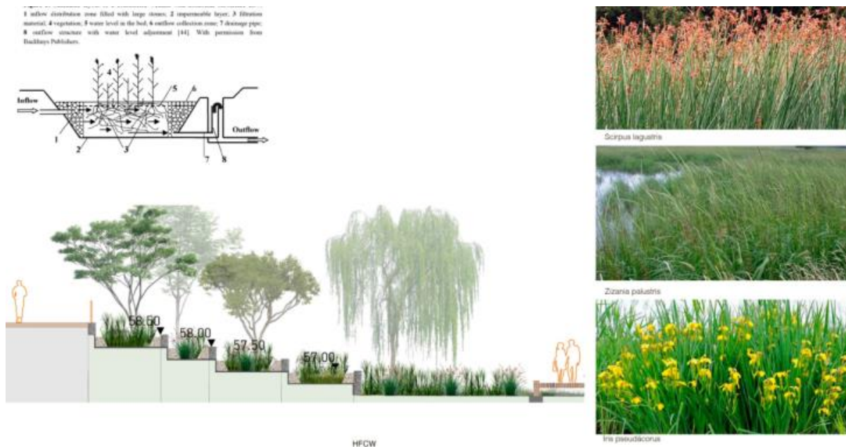
Рис. 6. Макет «Очистка воды фитофильтрами»
