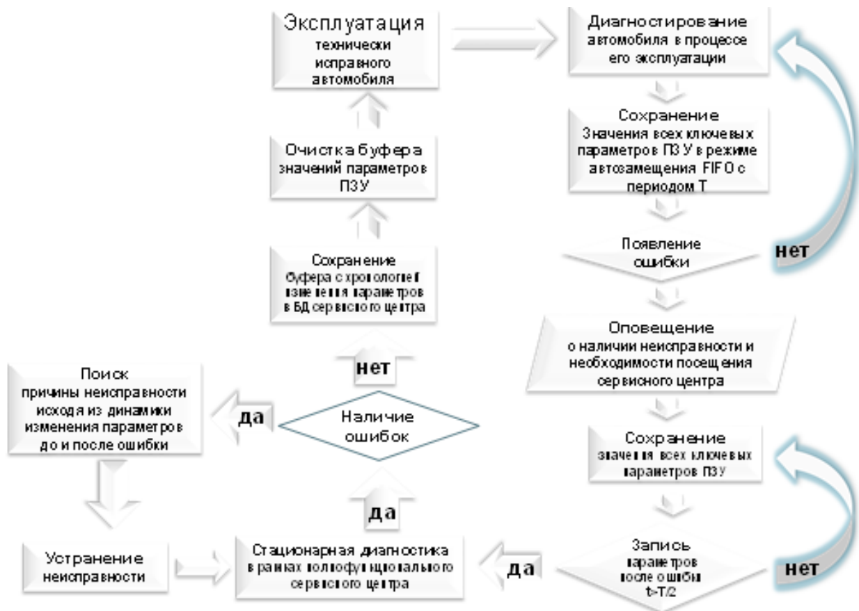
Рис. 6. Типичная схема алгоритма диагностирования с циклической записью параметров
