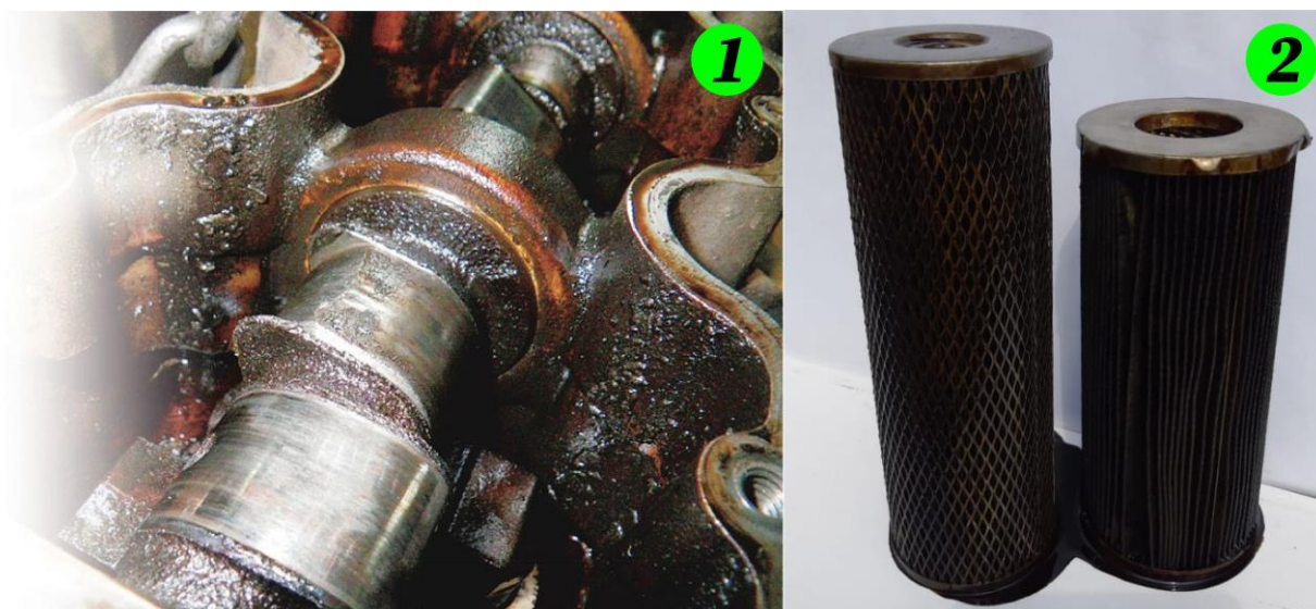
Рис. 4. Внешний вид: 1) коленчатого вала при несоблюдении элементарных требований к чистоте моторного масла в процессе работы двигателя; 2) масляных фильтроэлементов при несвоевременном обслуживании системы
