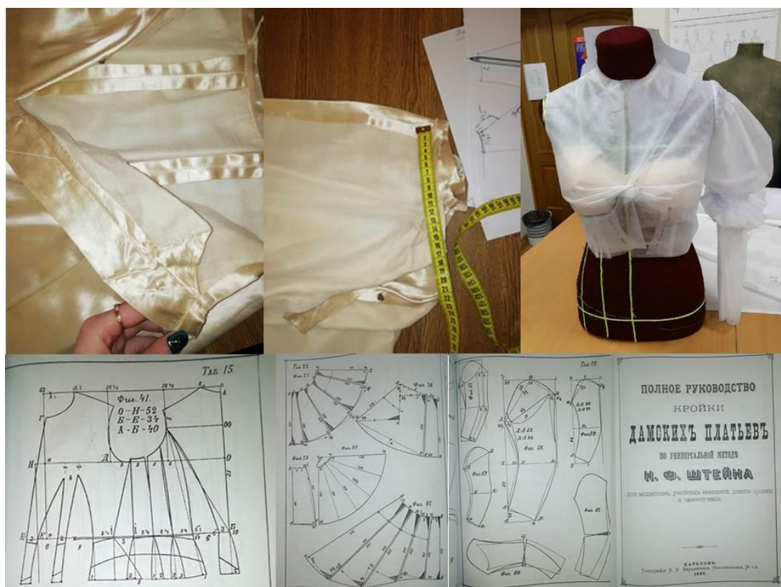
Рис. 4. Обмер образца, проработка по методике К.Ф. Штейна и совмещение конструкции на манекене
