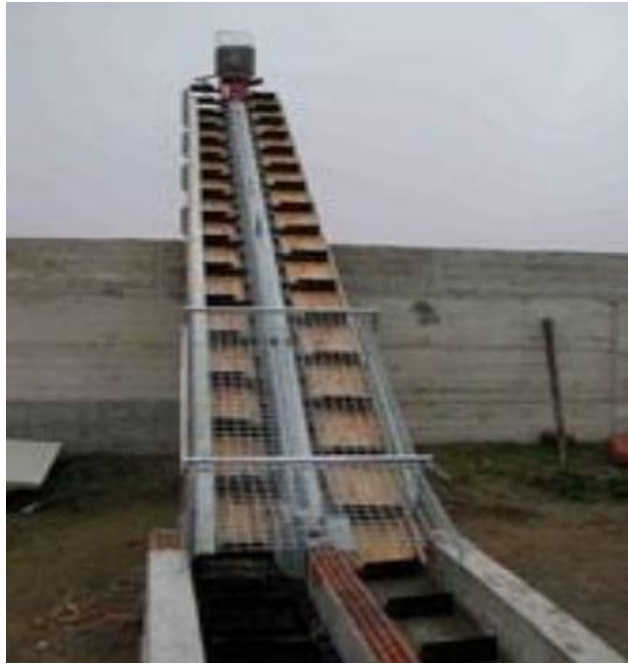
Рис. 7. Ленточная система удаления навоза
