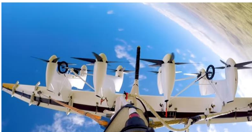
Рис. 5. Ветровые электрогенераторы Makani
