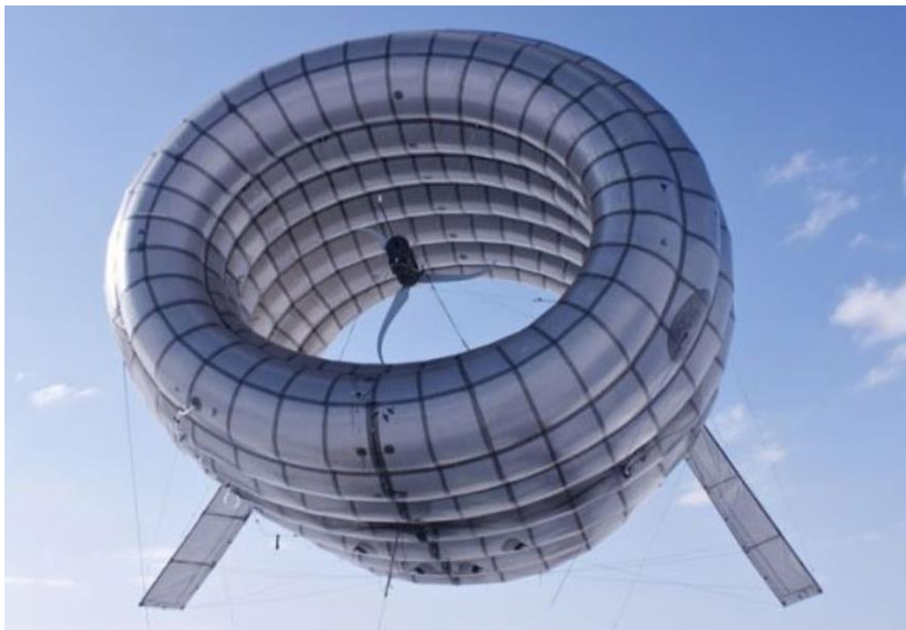
Рис. 8. Летающая электростанция-дирижабль Buoyant Air Turbine
