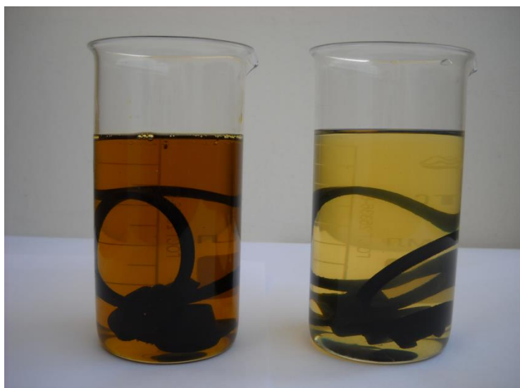
Рис. 2. Резинотехнические изделия фильтров слева в рапсовом масле; справа в товарном дизельном топливе
