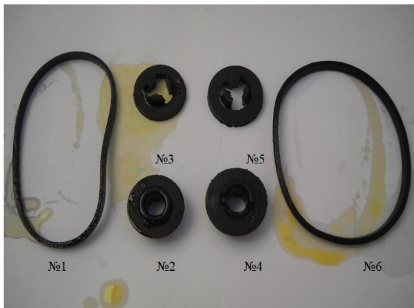
Рис. 4. Резинотехнические изделия (рем. комплект фильтра тонкой очистки топлива), извлеченные из емкости с рапсовым маслом (№ 1,2,3) и товарным дизельным топливом (№ 4,5,6).
