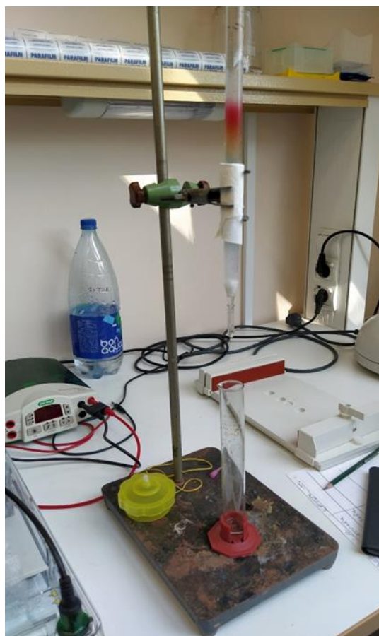
Рис. 1. Установка для гель-фильтрации (фото автора)
