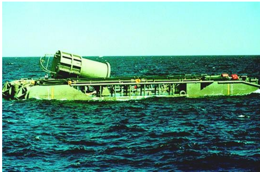
Рис. 7. Причальный буй одноякорного типа быстрого развертывания компании SOFEC
