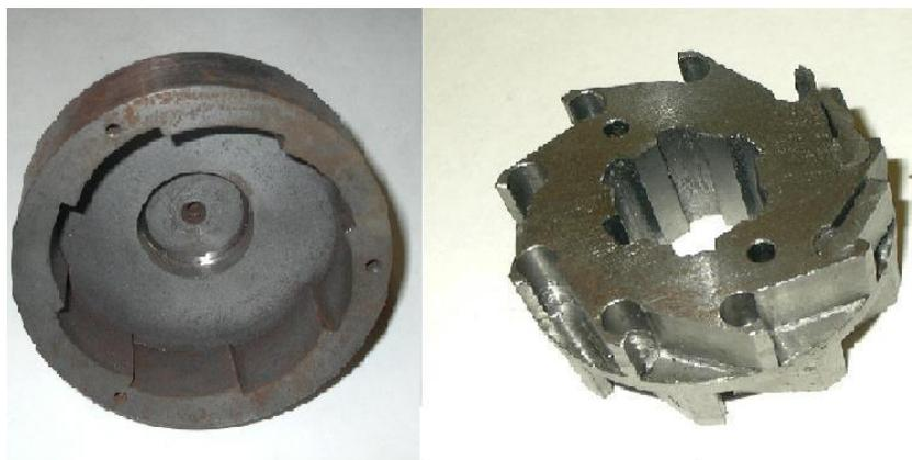
**Рис. 1. Храповой МСХ блочного типа внутреннего зацепления**
