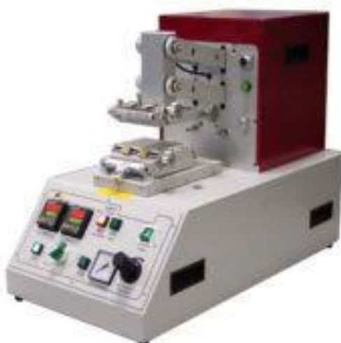
Рис. 3. Установка для определения износостойкости текстильных нитей
