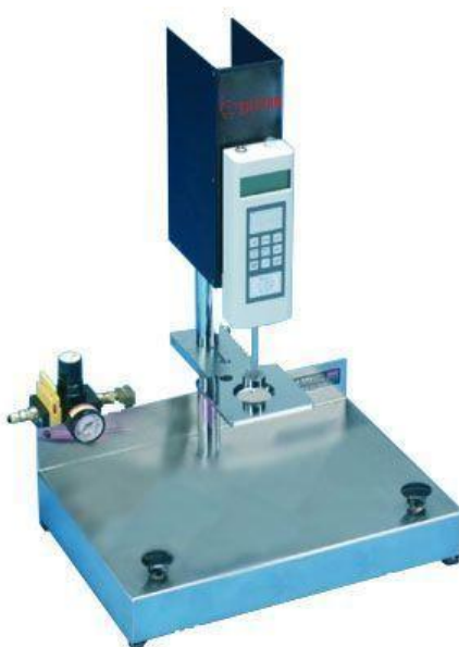
Рис. 2. Прибор для определения жесткости нитей
