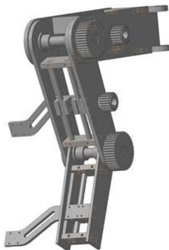
**Рис. 2. Трехмерная модель манипулятора для экзоскелета**
