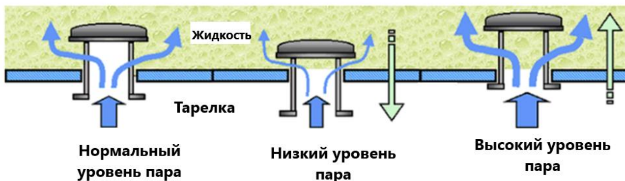
Рис.2. Прохождение пара через клапанную тарелку
