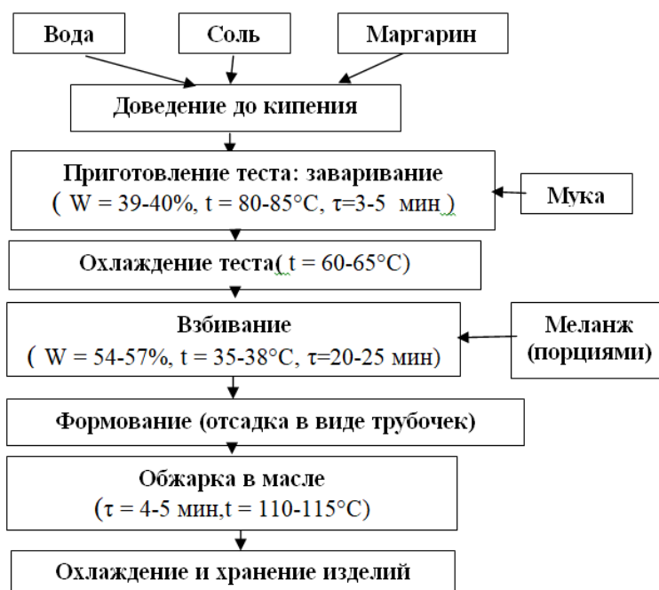
Рис. 1. Технологическая схема приготовления чуррос
