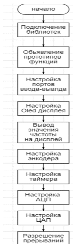
Рис. 2. Алгоритм действий для работы радиоприёмника
