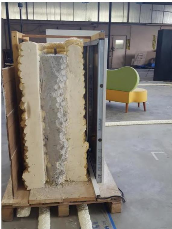
**Рис. 4. Заполненный бетоном каркас**
