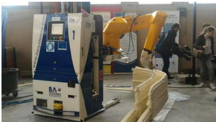
**Рис. 3. Печать каркаса для заполнения бетоном**
