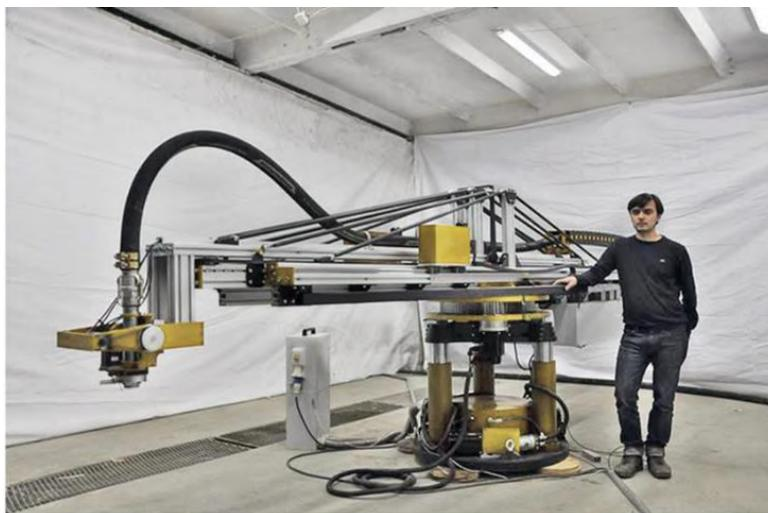
**Рис. 1. Принтер – тип «башенный кран»**
