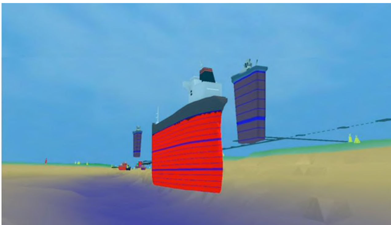
Рис. 3. 3D ЭНК, отображающая подводный рельеф при следовании судна вблизи причалов
