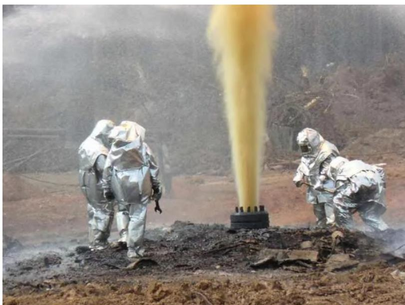
**Рис. 1. Газонефтиводопроявление**
