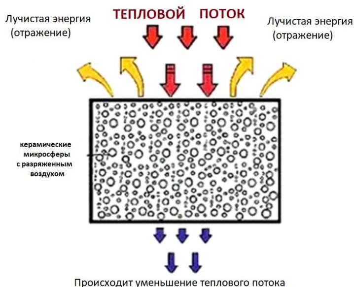
**Рис. 3. Принцип работы утепляющей краски**
