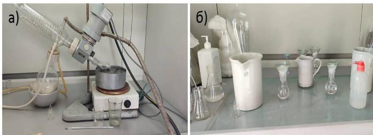
**Рис. 1. а) Ротационный испаритель для отгонки смеси гексана и растворенных в нем хлорорганических пестицидов и токсичных веществ; б) конические колбы для лабораторных анализов**
