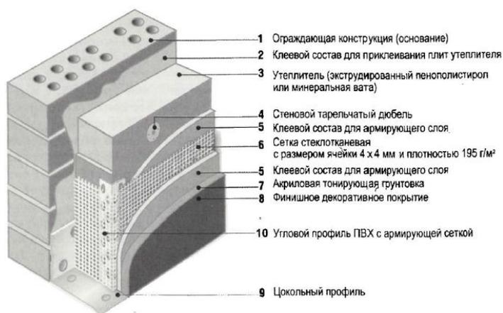
**Рис. 1. Конструкция мокрого фасада**
