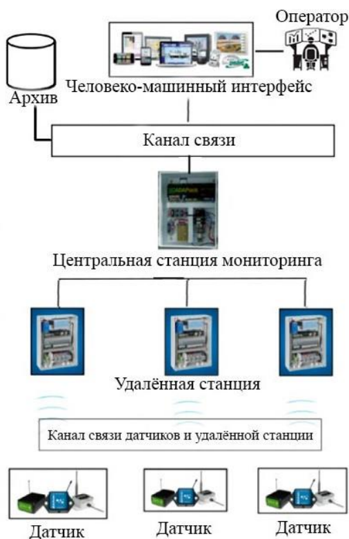
Рис. 1. Компоненты системы с архитектурой SCADA
