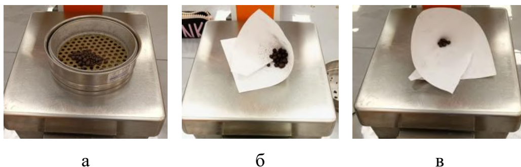
Рис. 2. Классификация с помощью сита: а – масса всего продукта; б – окатыши с сапонитом > 8 мм; в – окатыши с бентонитом > 8 мм
