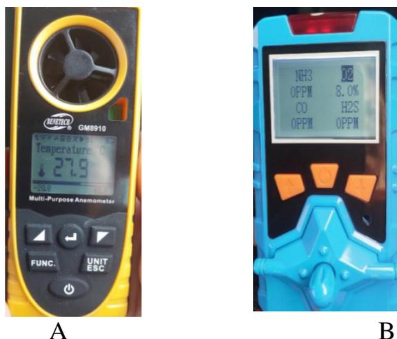
**Рис. 3. Приборы, используемые для определения температуры воздуха, состава и количества газа в нем
