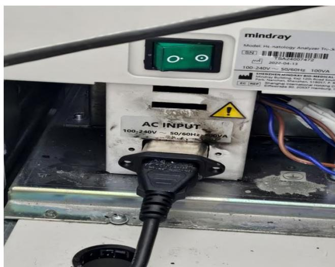
**Рис. 1. Последствия аварийного выхода из строя различного электротехнического оборудования**
