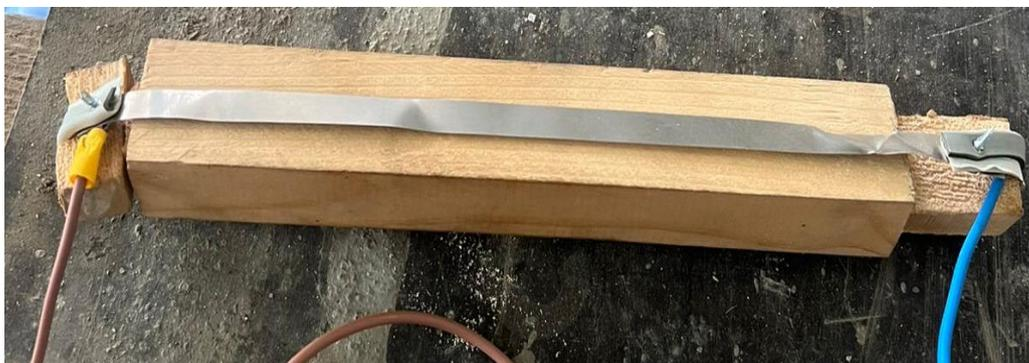
**Рис. 4. Нихромовая лента, закрепленная на брус с подключением проводов**
