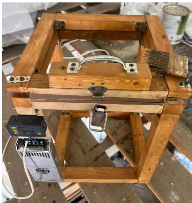
**Рис. 7. Макет запаечного устройства для полипропиленовых мешков**
