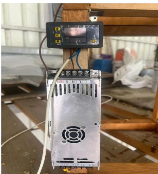
**Рис. 6. БП с таймером Т3230**
