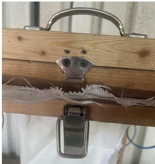
**Рис. 5. Металлическая защелка для обеспечения равномерного давления**
