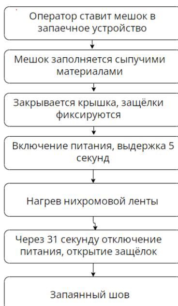
Рис. 8. Блок схема работы системы
