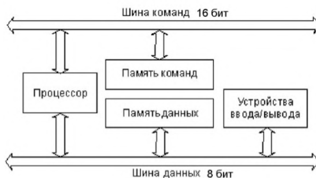
Рис. 1. Упрощенная структурная схема микроконтроллера ATmega328P-AU
