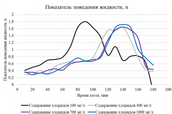
Рис. 7. Показатель поведения n жидкости разрыва с различным содержанием анионов Cl -
