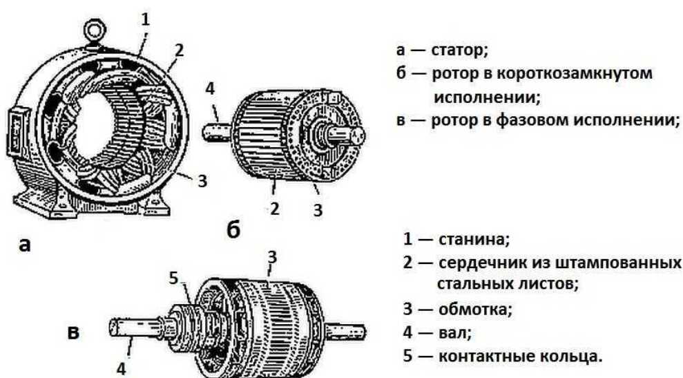
Рис. 2. Конструкция статорной и роторной обмоток АД [7]
