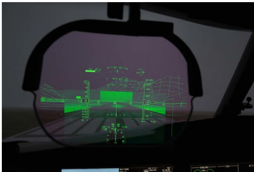
Рис. 5. Наложение изображений EVS на базе миллиметрового радара и SVS
