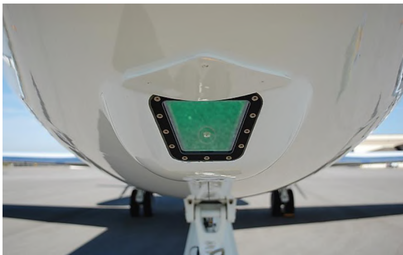
Рис. 4. Расположение датчика EVS на легком пассажирском самолете
