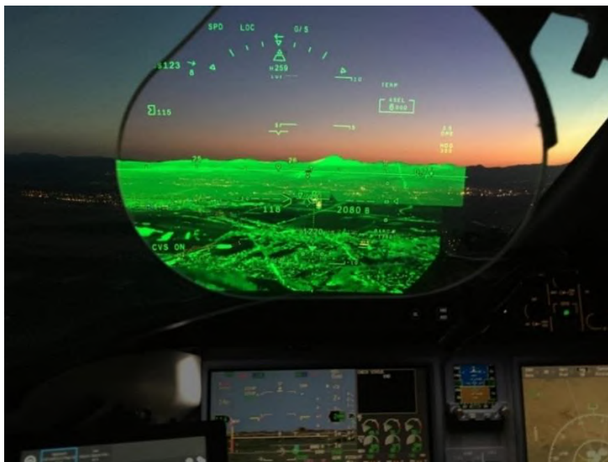
Рис. 1. Изображение на индикаторе на лобовом стекле информации от системы EVS ИК-типа
