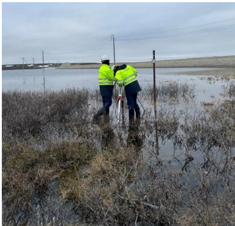
Рис. 2. Установка базовой станции над репером
