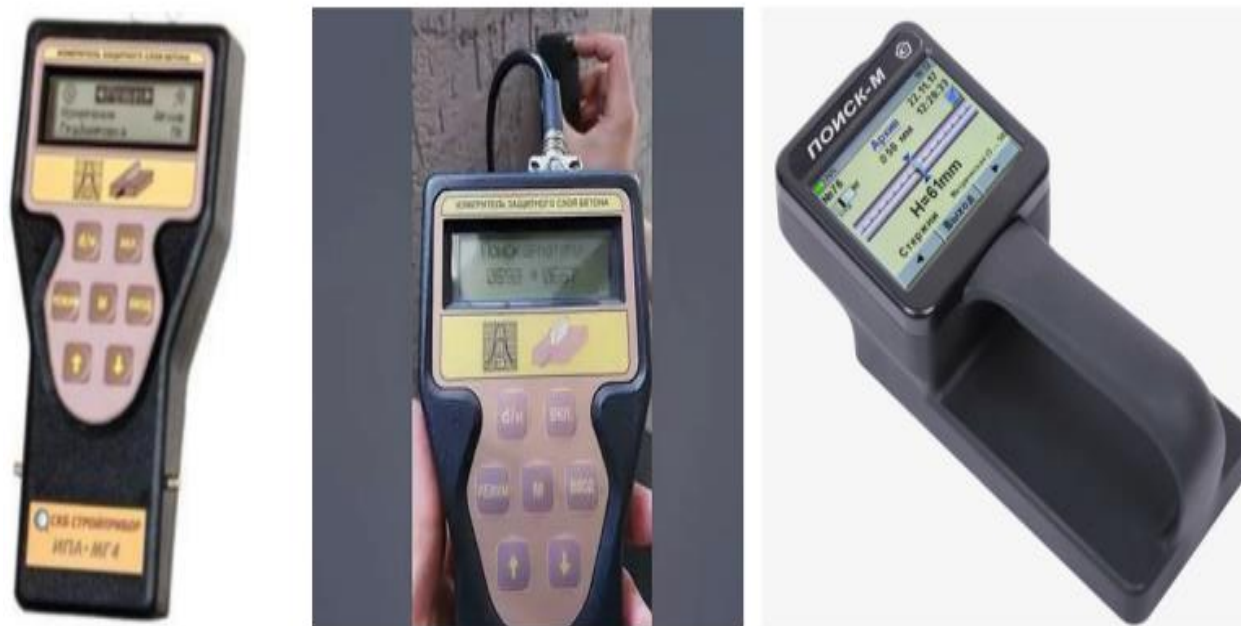
Рис. 2. Приборы определения толщины защитного слоя бетона и расположения арматуры ИПА-МГ4 и ПОИСК-М
