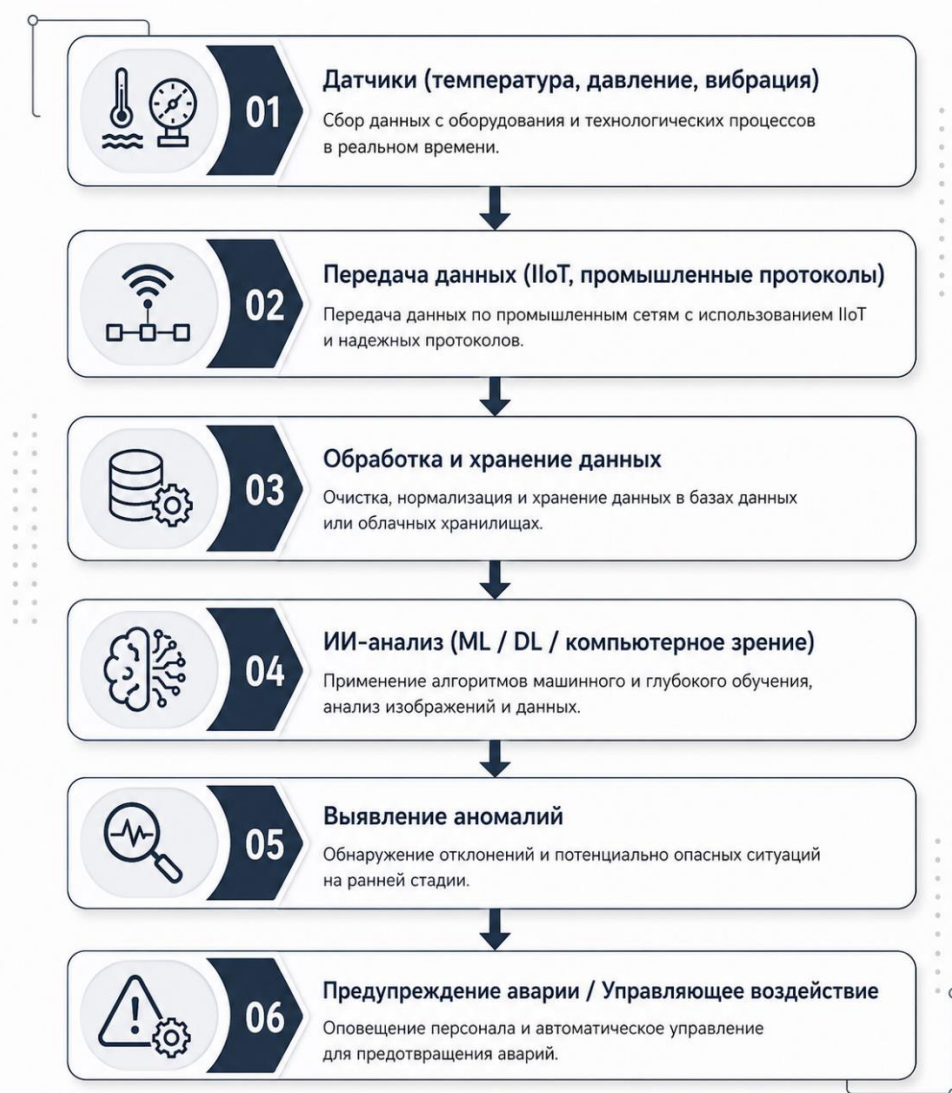
Рис. 1. Схема процесса цифрового мониторинга металлургического производства
