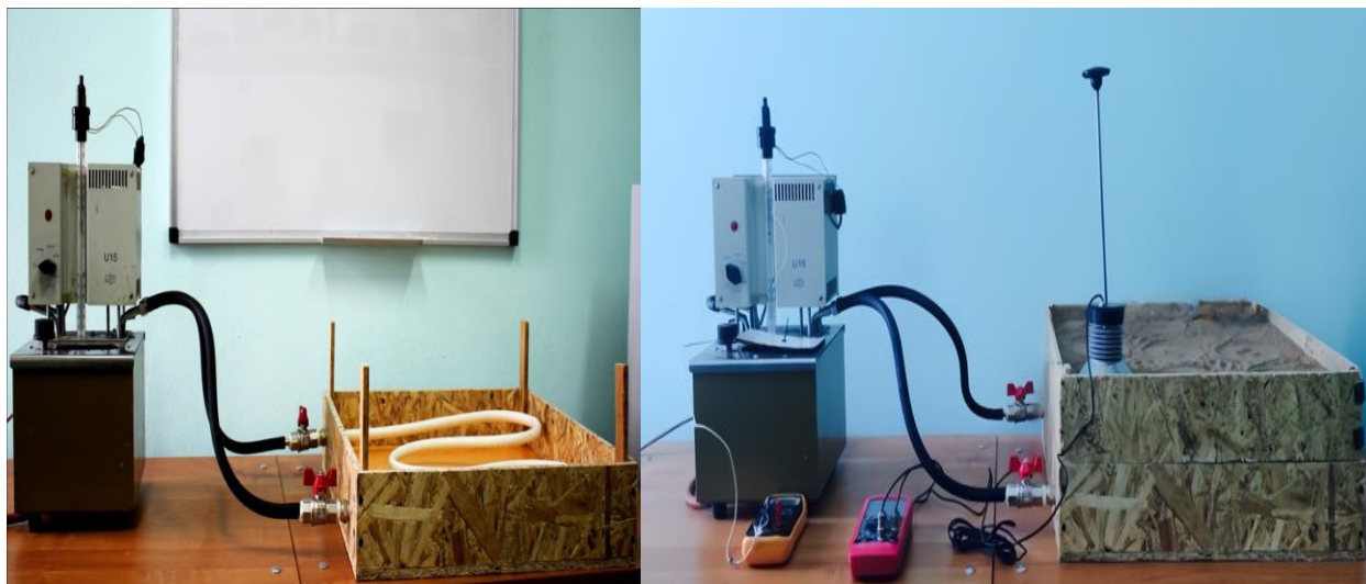
Рис. 2. Экспериментальный стенд мнимой подземной конструкции
