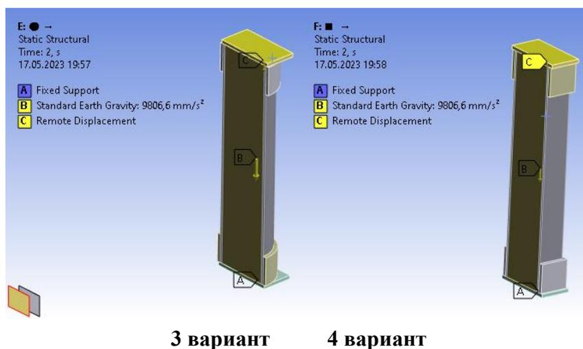
**Рис. 5. Приложенные нагрузки и граничные условия при внецентренном сжатии**
