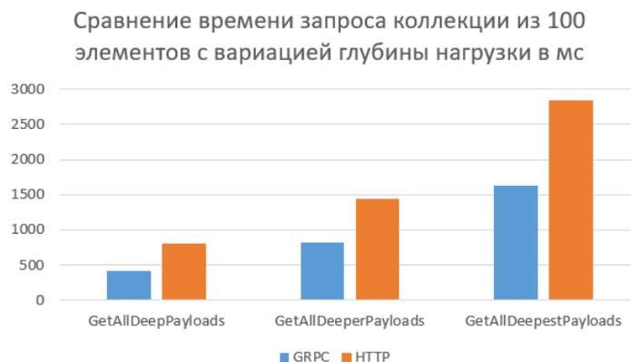
**Рис. 51. Диаграмма сравнения времени запроса коллекции из 100 элементов с вариацией глубины нагрузки**
