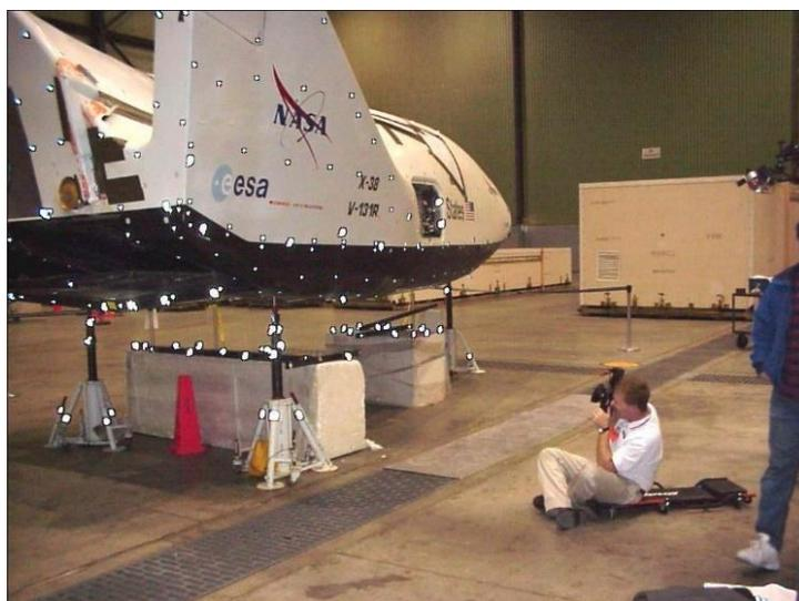
**Рис. 2. Процесс сканирования фотограмметрической системой «TRITOR»**
