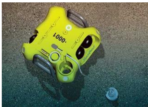
Рис. 3. Донная сейсмическая станция CASE Abyss
