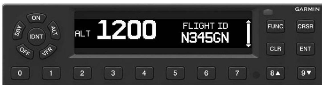
**Рис. 7. Панель управления транспондера GARMIN GTX-345**
