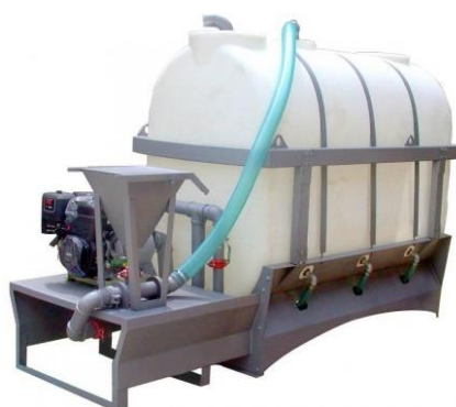
Рис. 10. НСУ ГНБ для бурового раствора
