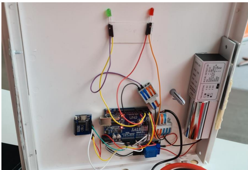
Рис. 1. Подключение Arduino Uno к вайфай модулю
