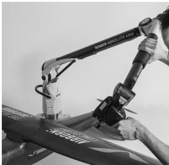
Рис. 4. Работа со сканером закреплённым на КИМ
