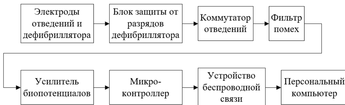
Рис. 1. Структура и состав многоканального электрокардиографа
