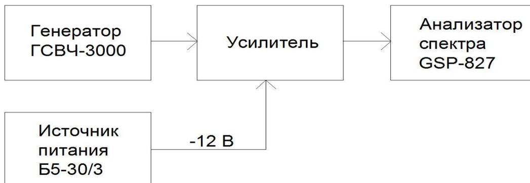
**Рис. 2. Структурная схема измерительной установки**
