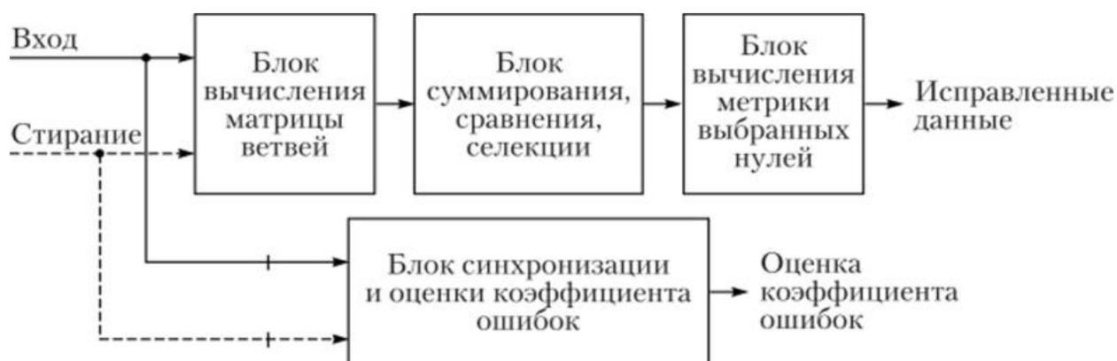
**Рис. 4. Структурная схема декодера Витерби**
