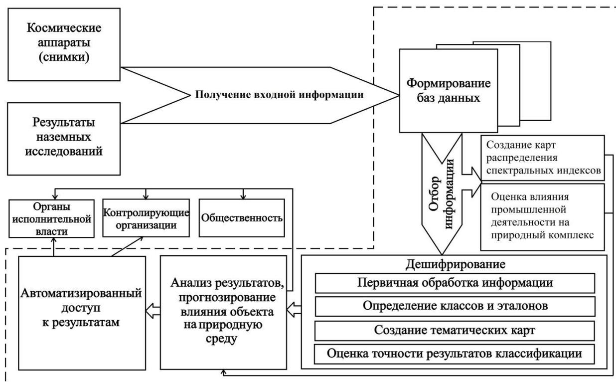
**Рис. 1. Структура аэрокосмического мониторинга природного комплекса в районе действия промышленного объекта**
