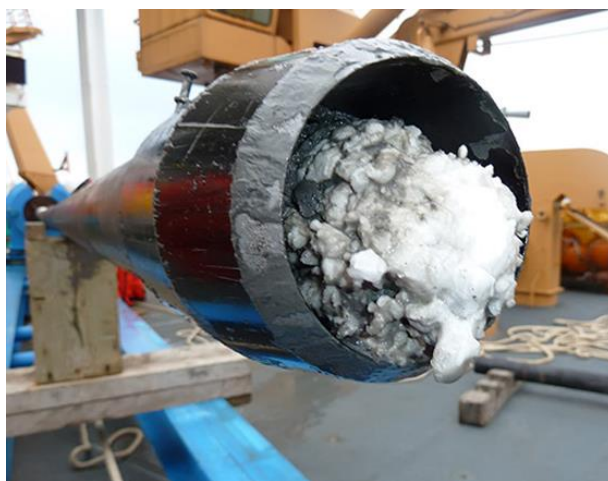
Рис. Газогидратная пробка в трубопроводе (Gas hydrate plug)
