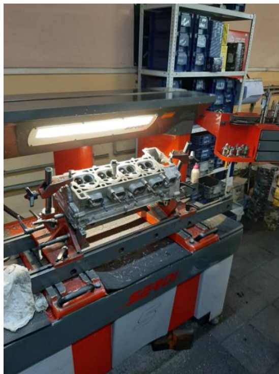
Рис. 2. Расточка седел клапанов ГБЦ на станке SERDI.
