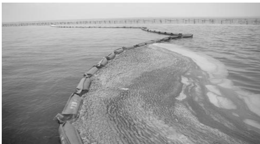
Рис. 1. Барьеры (боны) сорбирующие для локализации разливов нефти, нефтепродуктов, агрессивных и неизвестных жидкостей [4]
