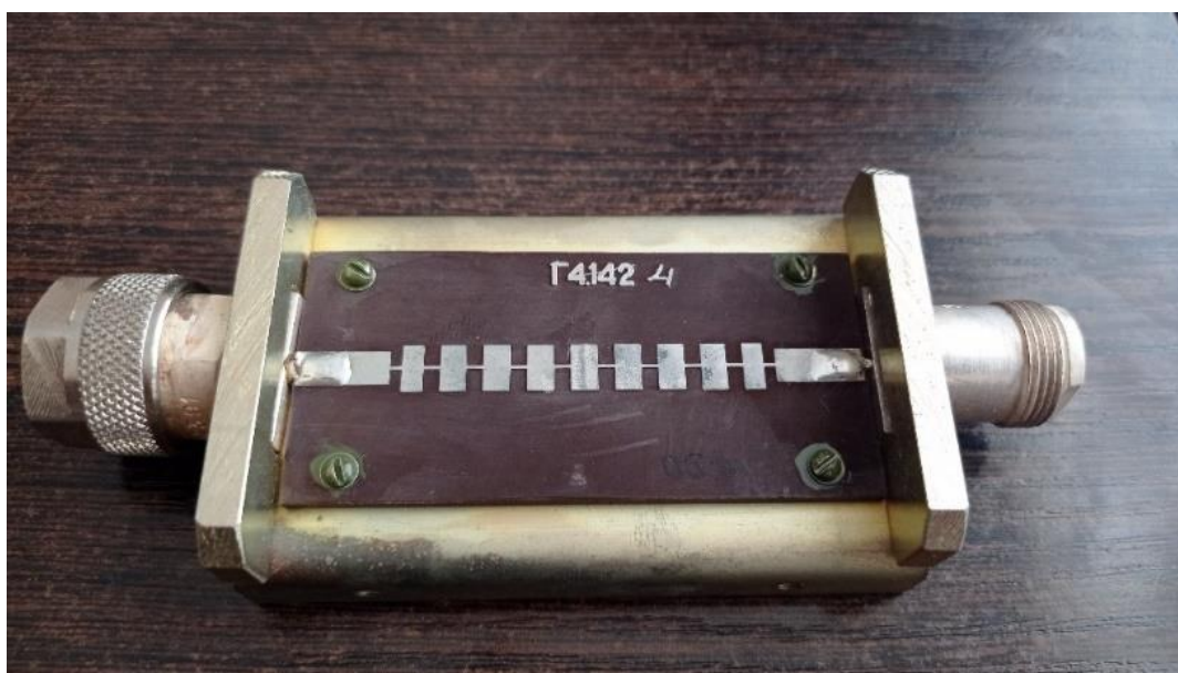
Рис. 2. Фото фильтра нижних частот с ( f_{cp} = 7,5 ГГц)
