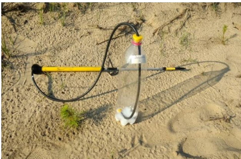
Рис. 3. Распылитель для обработки надземной части лесных культур сосны крымской
