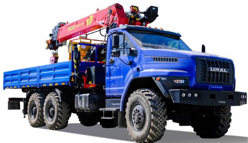
Рис. 1. Бортовой автомобиль на шасси Урал Next с КМУ ИТ-200
