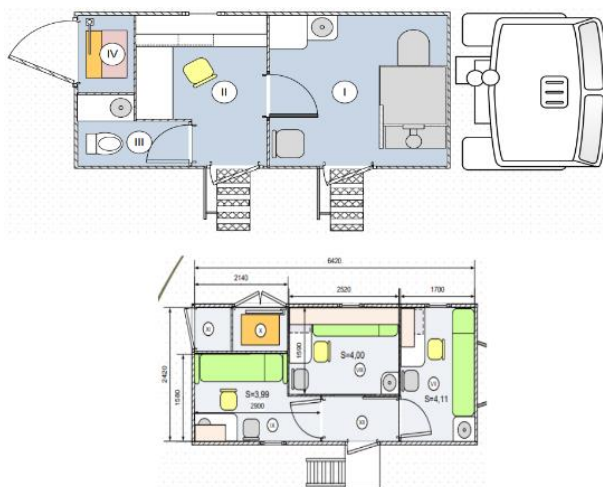
Рис. 2. Пример компоновки автомобиля КАМАЗ с мобильным флюорографом
