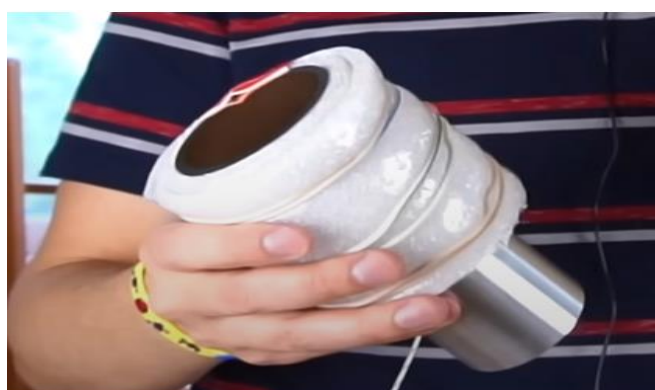
Рис. 2. Теплоотводящий цилиндр с теплоизоляцией
