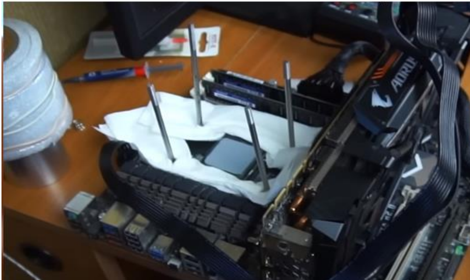
Рис. 3. Изоляция свободного пространства пористым материалом
