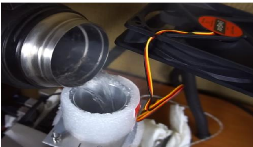
Рис. 5. Система внешнего обдува охлаждающего цилиндра
