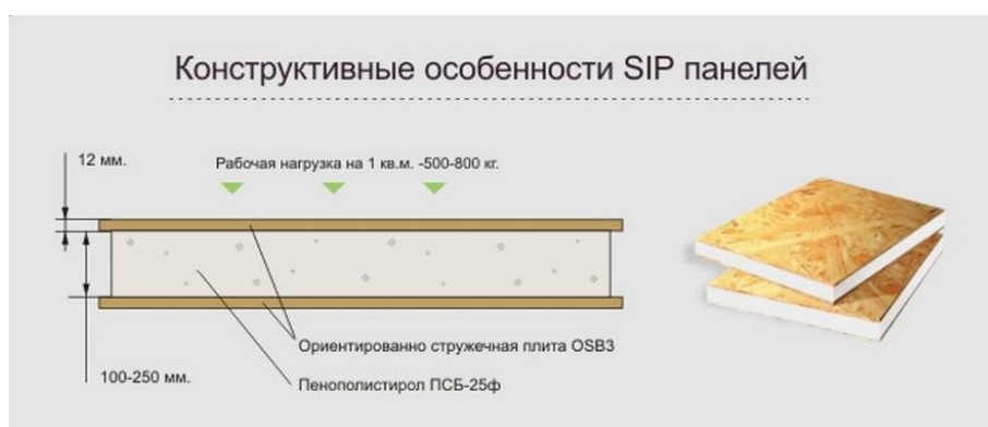
Рис. 2. Конструкция плиты «SIP»
