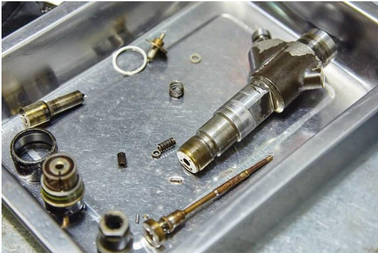
Рис. 1. Неисправная форсунка Common Rail в разобранном состоянии со следами коррозии
