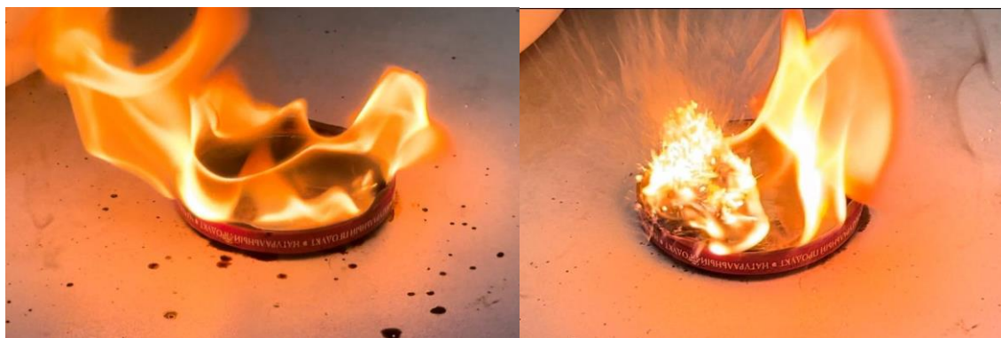
Рис. 2. Горение нефти в резервуаре (слева – разбрызгивание нефти при её горении; справа – при тушении водой)
