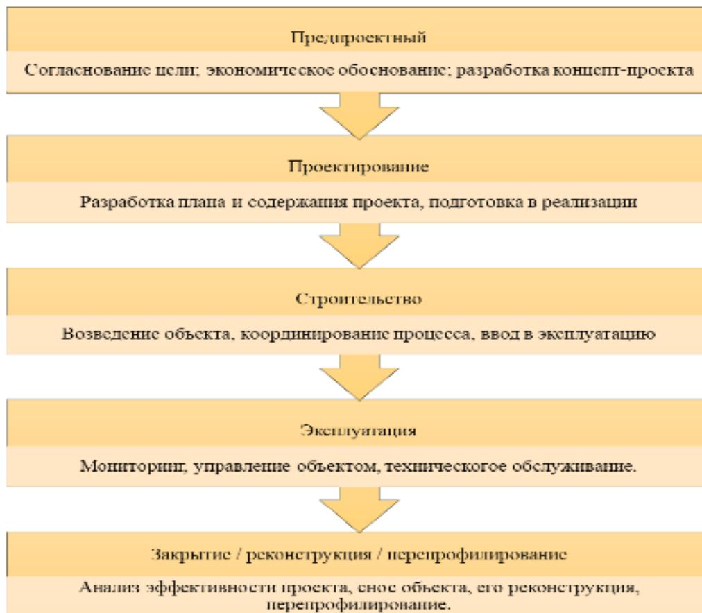
**Рис. 1. Жизненный цикл инвестиционно-строительного проекта**
