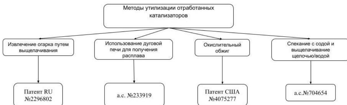
**Рис. 1. Методы утилизации отработанных катализаторов**
