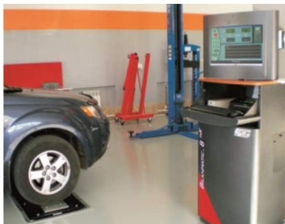
Рис. 2. Стендовая проверка работы подвески на автомобиле
