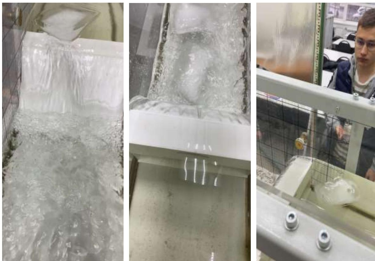
**Рис. 3. Проведение экспериментов по пропуску льда через водослив**
