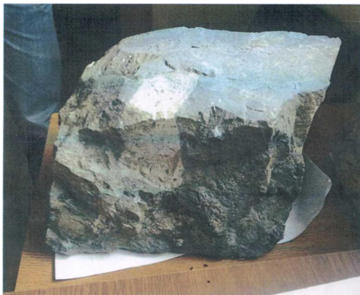
Рис. 10. Ксенолиты плагиогранитогнейсов беломорского комплекса (светло-серая окраска) размером до 20 см в щелочных дайках Прихивинского месторождения.
