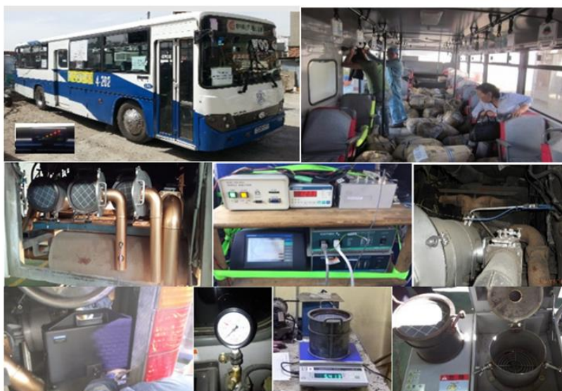
Рис. 2. Автобус, подготовленный к испытаниям, взвешивание и регенерация фильтра
