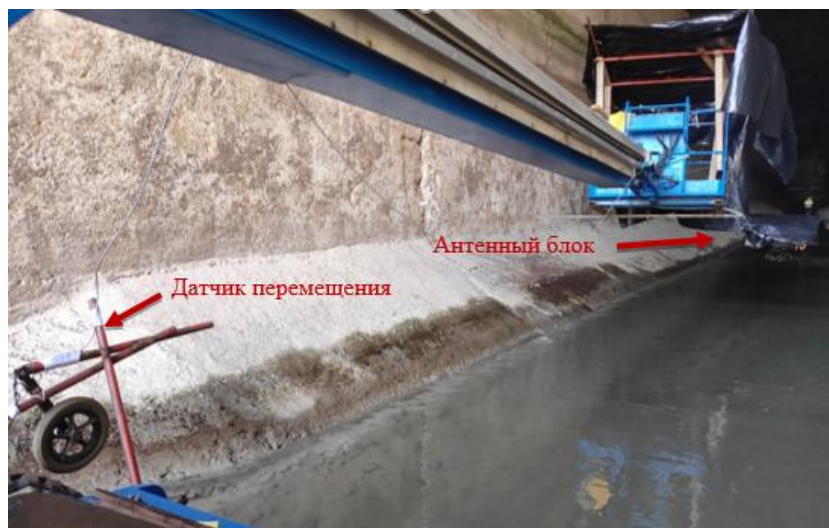
Рис. 5. Расположение элементов георадарной системы на автогидравлическом подъемнике в трубе № 3
