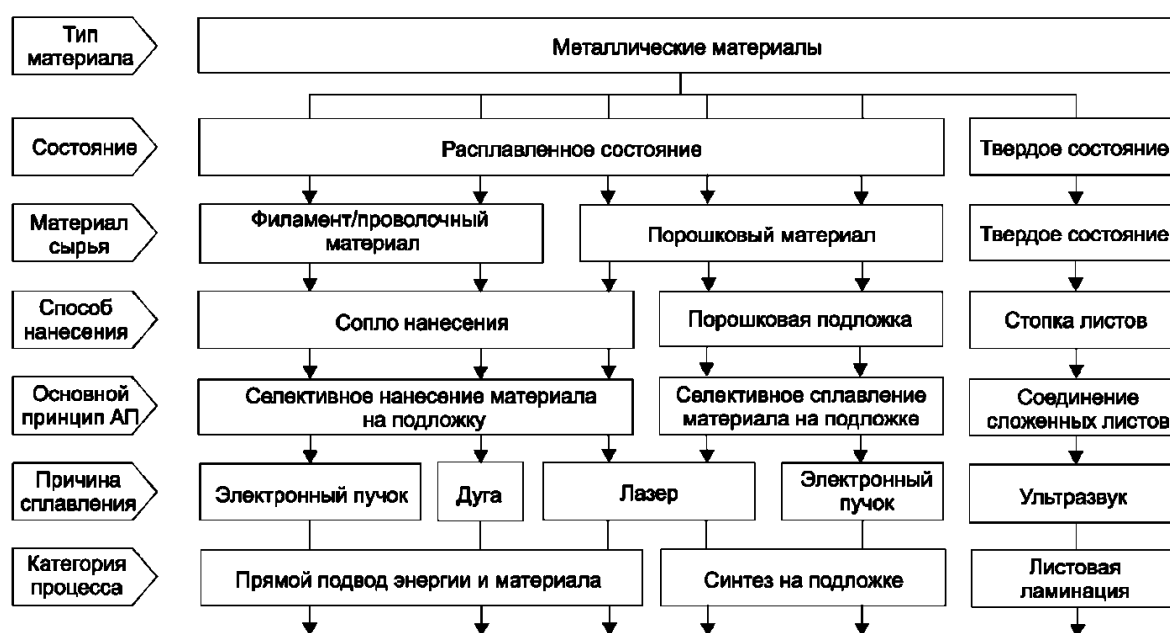
Рис. 1. Аддитивные технологические процессы для металлических материалов [1]
